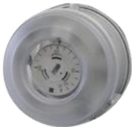
Измеряет перепад давления, который является показателем загрязненности фильтра в завесах с подводом горячей воды. Замеры производятся до и после фильтра перед теплообменником на стороне забора воздуха. Замеры производятся по месту установки завесы, а их периодичность зависит от степени загрязненности данного помещения. Диапазон замеров 20-300Па. Сухой контакт, настраиваемый сигнал аварии.
