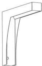
Скобы для горизонтальной навески занавесы на стене. Две скобы для занавес длиной 1 и 1.5 метра, три - для занавес длиной 2 и 2.5 метра и четыре - длиной 3 метра.
