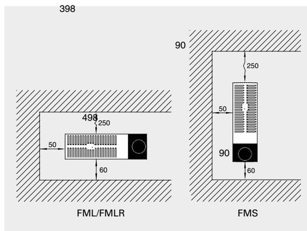
Рисунок 1: Минимальные расстояния при подвеске на стену.
